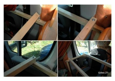
Après avoir glissé le pieds sous le bout des traverses (pour éviter l'arrachement de celles-ci) Fixer les 2 longerons à l'aide des boulons de 5 X 60 (les inserts auront été placés auparavant dans les traverses avec un espacement de 400 mm)
