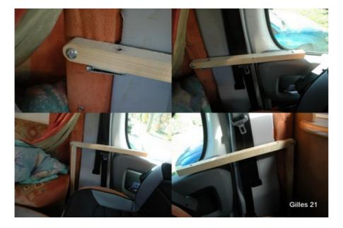
Fixer les 2 traverses (Boulons + INSERTS) 1 de chaque coté de la cabine après avoir percé (découper soigneusement le tissus avant perçage pour éviter le déchirement)
